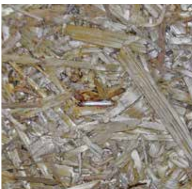
Oberflächenbündig gesetzte Klammer
