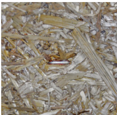
Oberflächenbündig gesetzte Klammer
